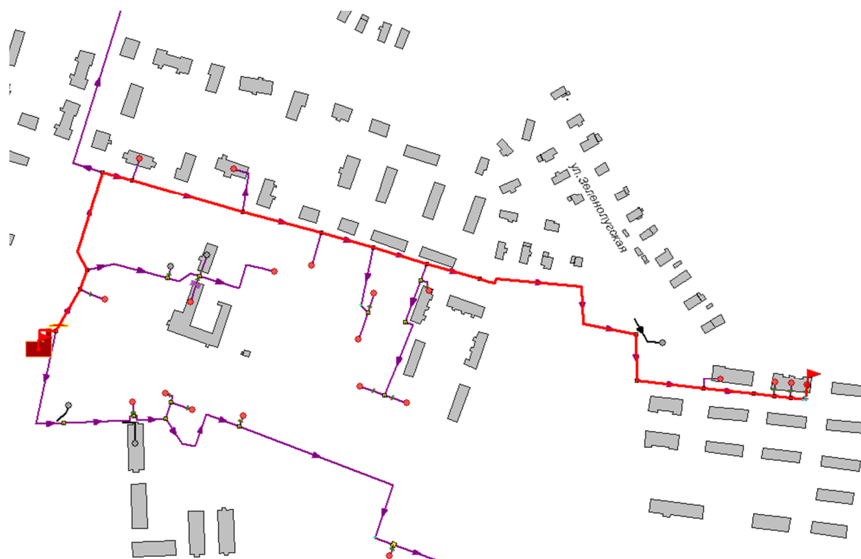
Рисунок 3.1 -Расчетный путь теплоносителя котельной до КЛДК 23, УУ1
