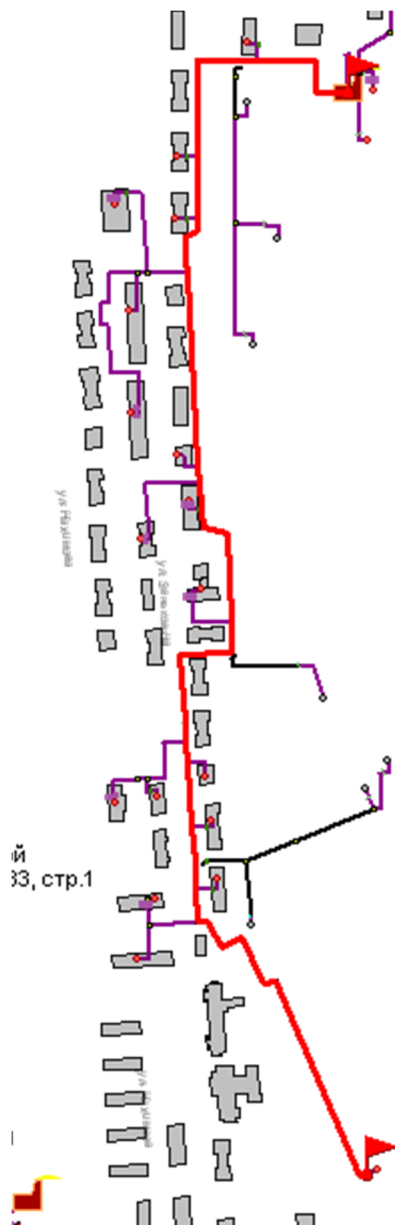
Рисунок 11.1 -Расчетный путь теплоносителя котельной до Пластмассового завода
