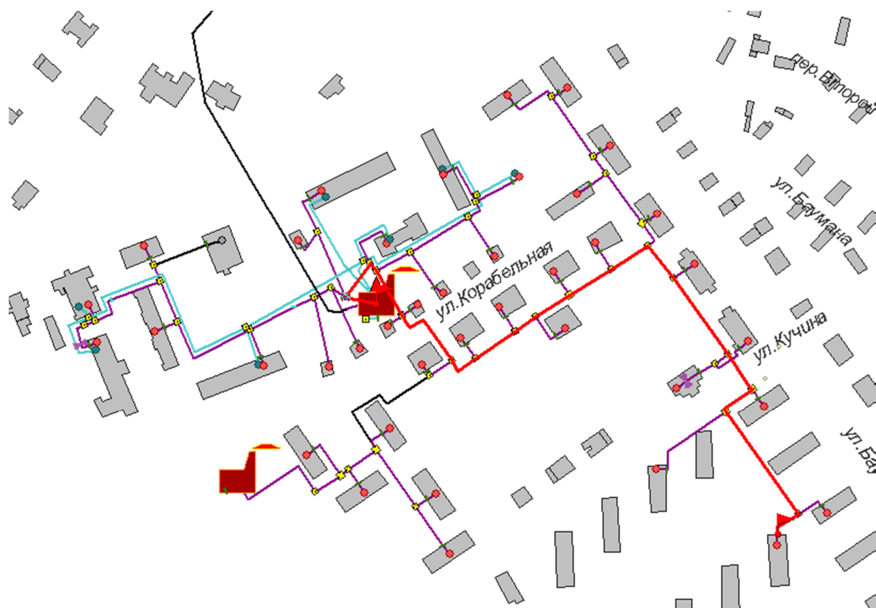
Рисунок 29.1 -Расчетный путь теплоносителя котельной до Баумана,12 к.4
