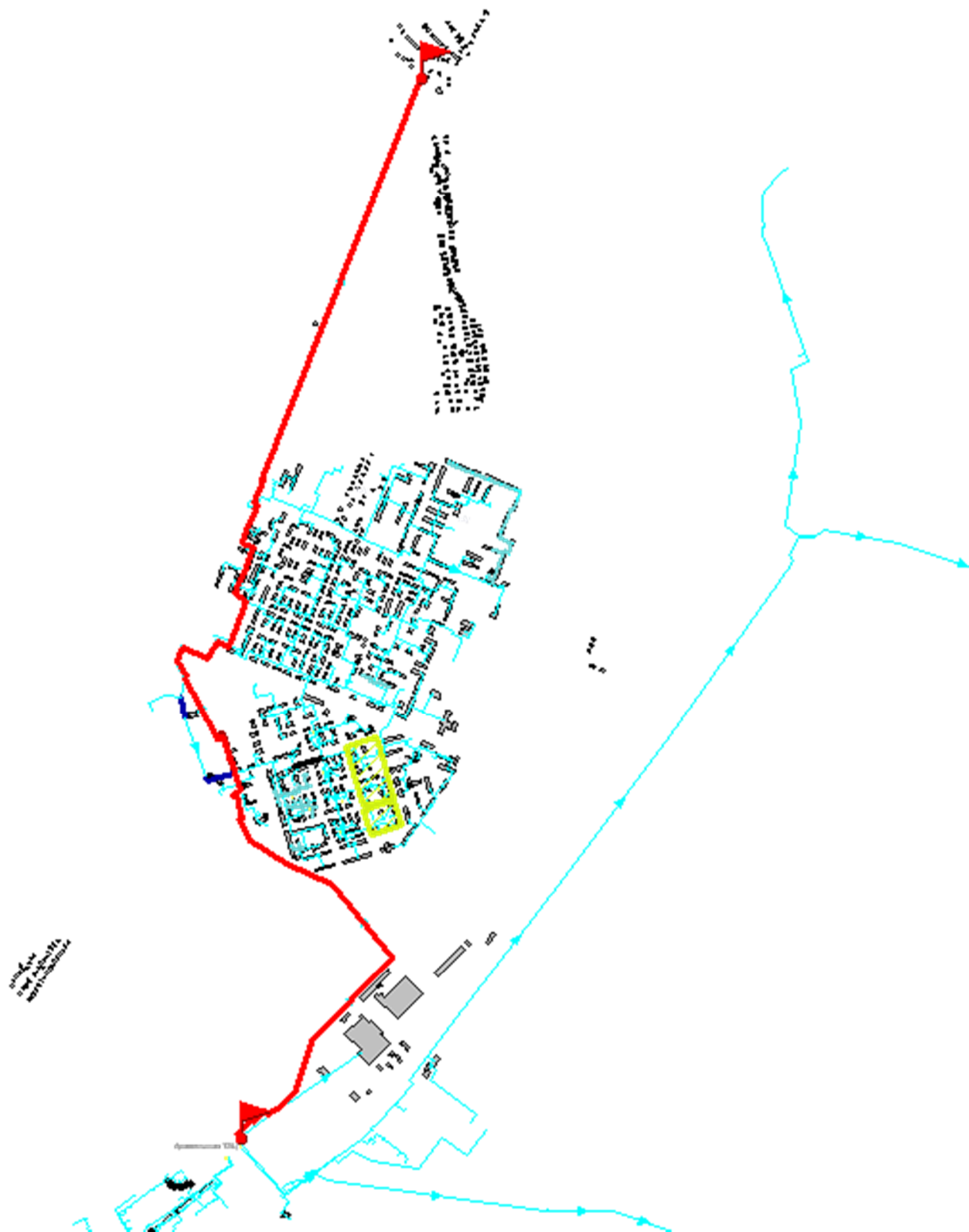
Рисунок 1.1 -Расчетный путь теплоносителя №1 от Архангельской ТЭЦ.
