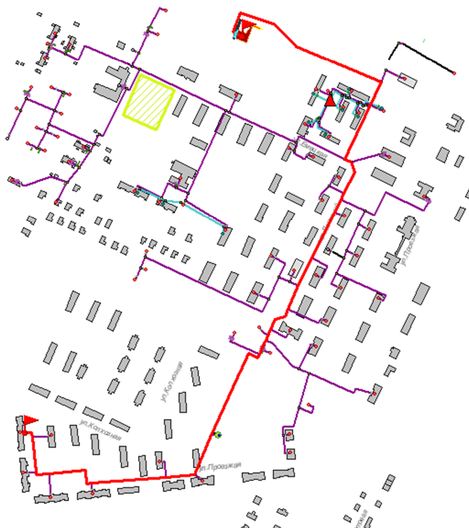
Рисунок 27.1 -Расчетный путь теплоносителя котельной до Колхозная,35
