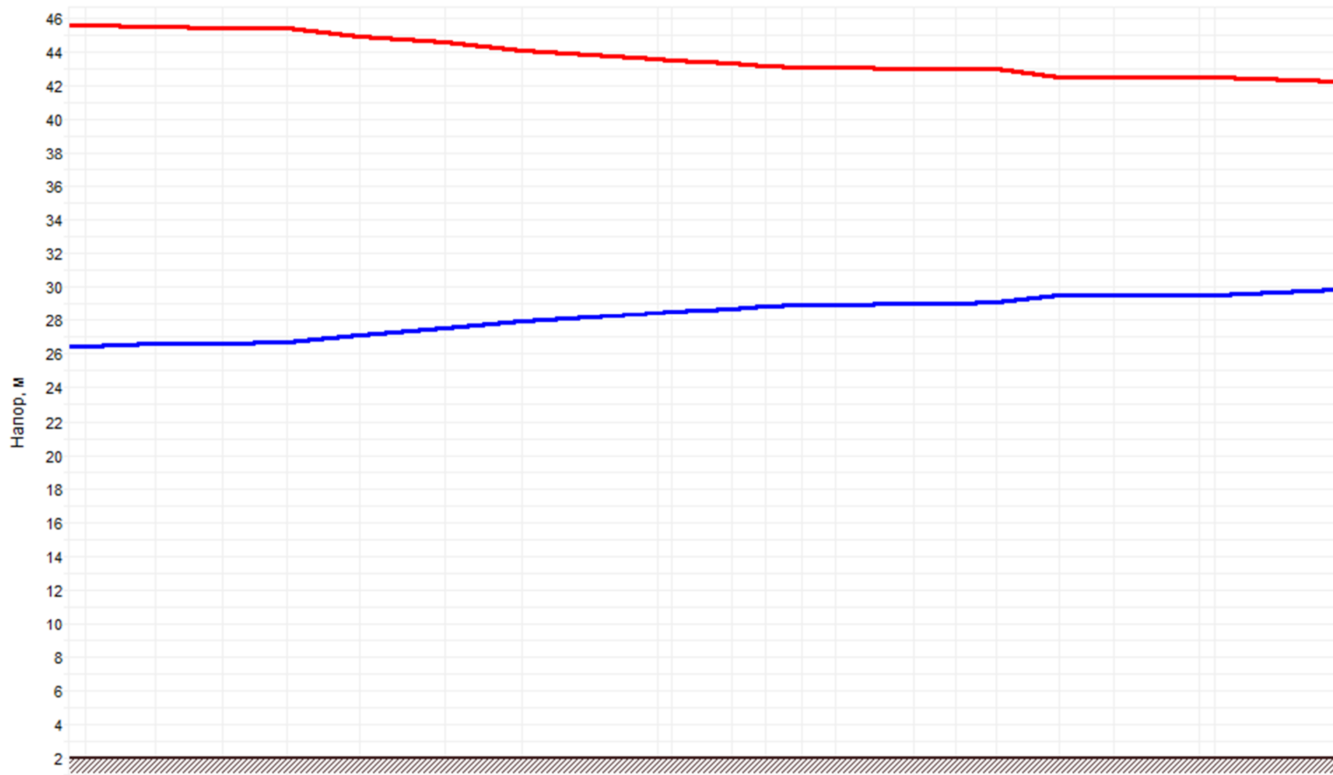
Рисунок 4.2 –График гидравлических режимов рассматриваемого теплопровода
