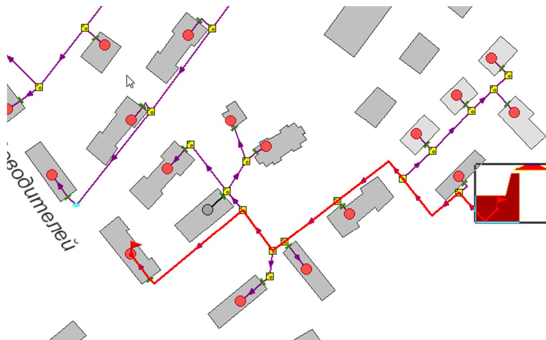
Рисунок 17.1 -Расчетный путь теплоносителя котельной до Речников,29
