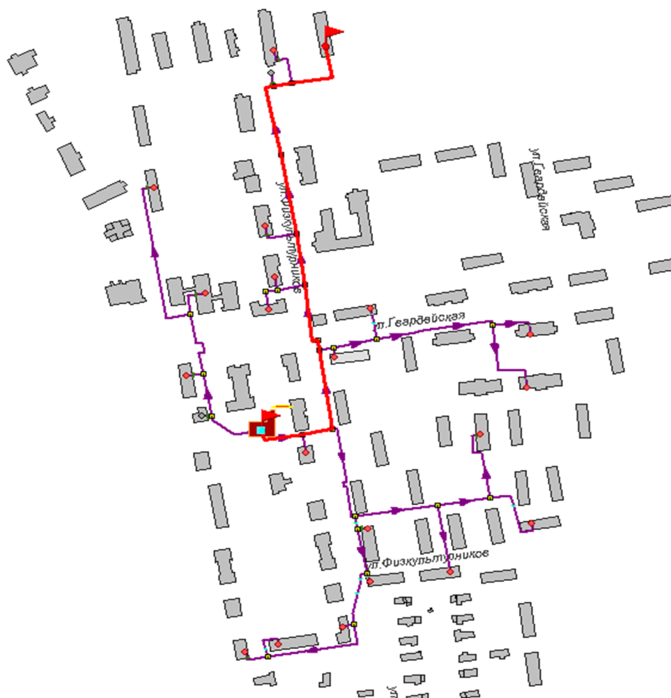
Рисунок 28.1 -Расчетный путь теплоносителя от котельной до Петрова,9
