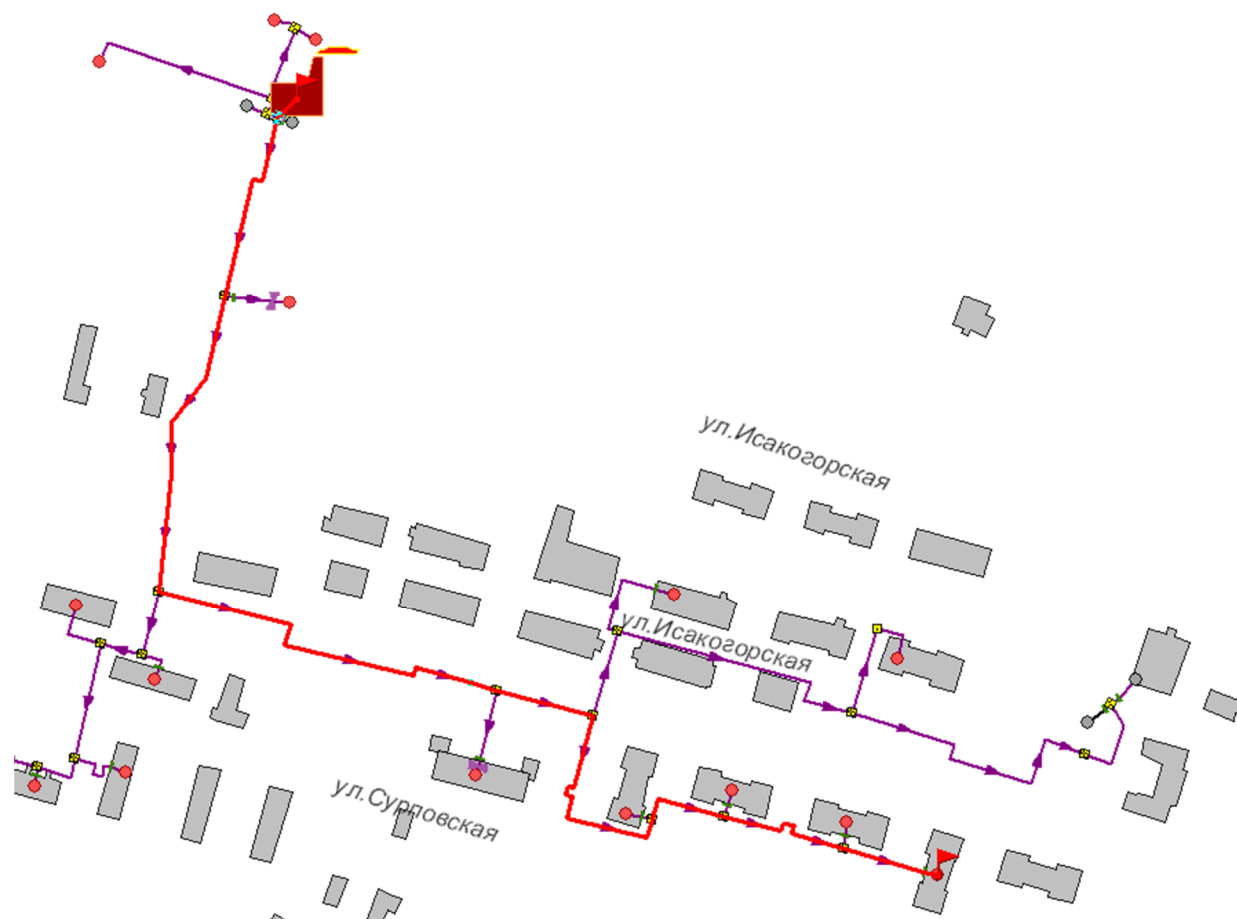
Рисунок 5.1 -Расчетный путь теплоносителя котельной до Сурповской, 20
